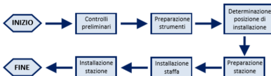
Figura 7 - Come procedere con l'installazione
